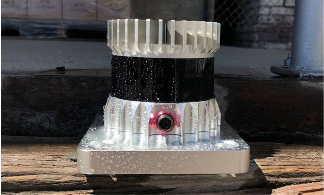
シャワーを浴びたばかりで、ビームの屈折障害物 (aka ウォーターの水滴) が付着している OS1
