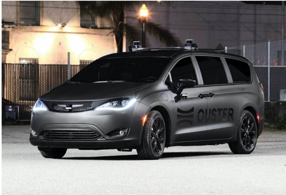
Ouster のデモ車両に搭載される OS0、OS1、OS2 ライダーセンサー
