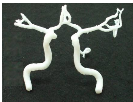
ABS で作成した脳血管 (シリコンでコーティングした後に、ABS を溶解・除去したモデル。ABS 製の台座 (骨) 付き)
