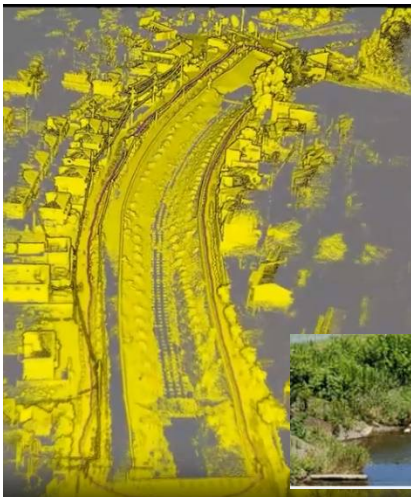
立木調査：SLAM スキャナーと OPT Cloud Survey 点群処理ソフトで立木調査を行なう
